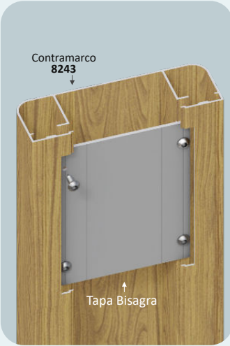
Fijación de Tapas en Contramarco
