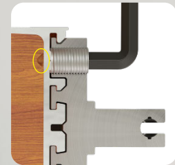
La Punta del Opresor Presiona sobre el Aluminio Fijando la Barra
