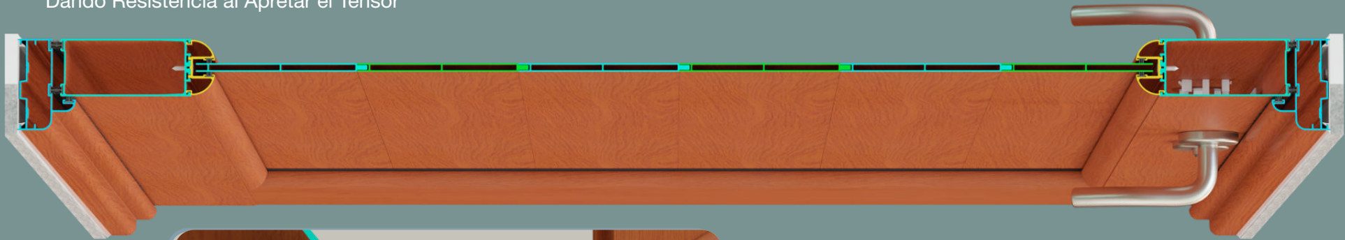
Cercos Chapa con Refuerzos en Paredes Interiores Dando Resistencia al Apretar el Tensor
