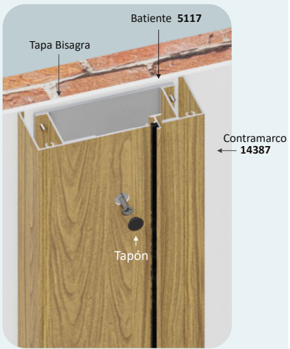
Fijación de Contramarco a Muro
